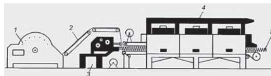
Slika 24: Linija za izdelavo vlaknovin, ki imajo vertikalno usmerjena vlakna [2, 3]
