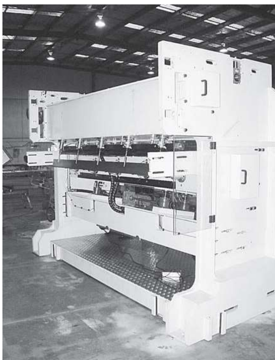
Slika 26: Polagalnik za vertikalno usmerjenost vlaken v kopreni V-lap [14]
