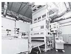
Slika 14: Zračni postopek izdelave temeljnega sloja Airfelt 2400 [9]
