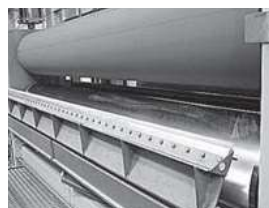
Slika 6: Prikaz izdelave temeljnega sloja in kemičnega utrjevanja lažjih vlaknovin s fularjem na podlagi sistema ADL izdelovalca Truetschler [7]
