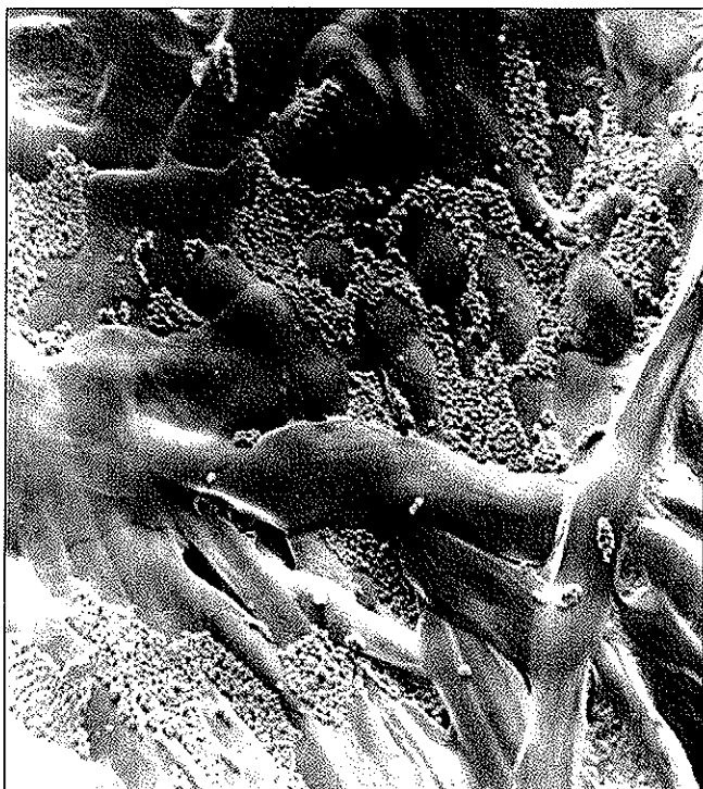
Slika 15: Premaz tkanine z mikrokapsulami (SEM posnetek, povečava: A - 190x, B - 1900x).
