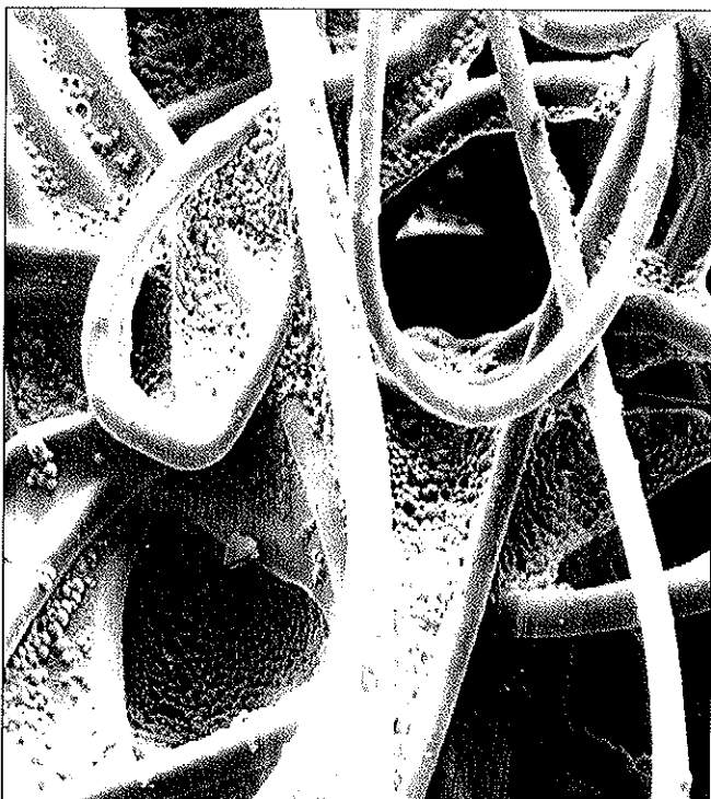
Slika 14: Impregniranje netkane tekstilije z mikrokapsulami (SEM posnetek, povečava 190x).
