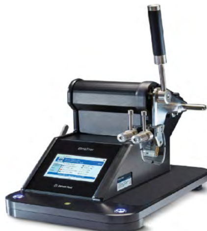
Slika 6: Naprava za določanje sile nadaljnega trganja Elmatear 1555 Intelligent Digital Tear Tester [11]
