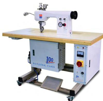
Slika 2: Ultrazvočni stroj za brezšívno spajanje tekstilnih materialov Ultrasonic BHU – 20 [7]
