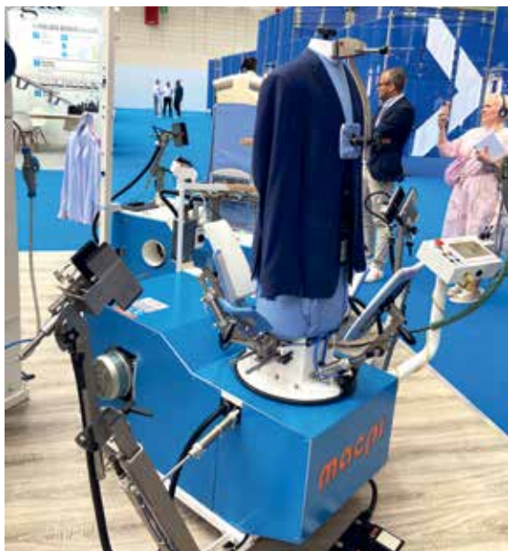
Slika 6: Dodatno likanje suknjiča na likalni napravi Macpi
