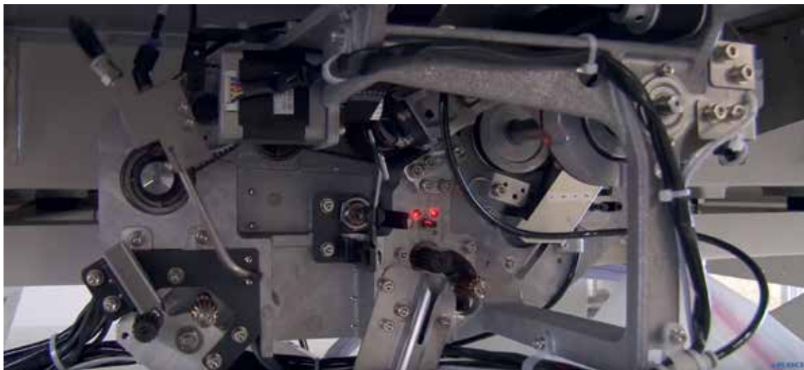
Slika 2: Naprava AW 3S Juki za avtomatsko navijanje in menjavo čolničnega sukanca [6]
