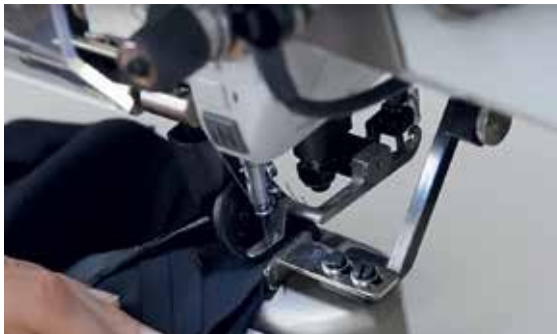
Slika 5: Šivalni stroj Pfaff 3834 – prikaz pritisnega valja ob šivalni igli [7]
