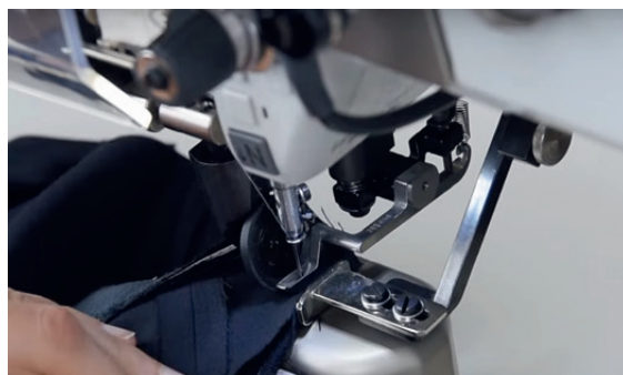
Slika 5: Šivalni stroj Pfaff 3834 – prikaz pritisknega valja ob šivalni igli [7]
