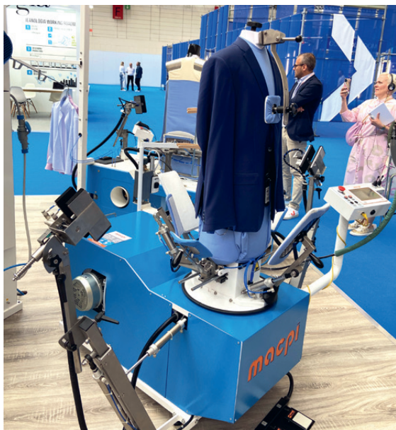
Slika 6: Dodatno likanje suknjiča na likalni napravi Macpi
