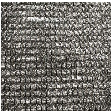
Slika 14: Netkana tekstilija Maliwatt iz recikliranih ogljikovih vlaken [12]
