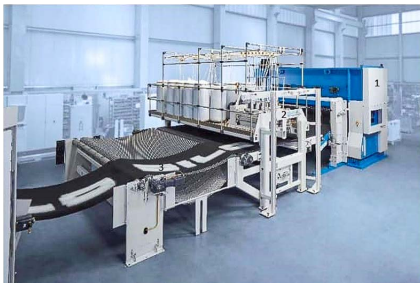
Slika 4: Dilova linija z vključenim sistemom »3-D loft« 1 - dovajanje koprane; 2 - sistem »3-D loft« 3 - izdelana 3-D tekstilija [5]
