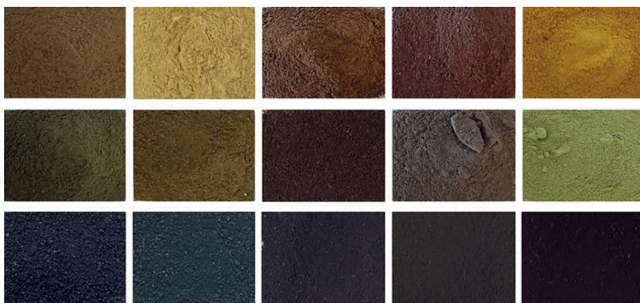
Slika 1: Pigmenti, pridobljeni iz delov invazivnih tujerodnih rastlin (z leve proti desni: plod in listi octovca, listi in korenika japonskega dresnika, cvetovi zlata rozge) in kovinskih soli (od zgoraj navzdol: aluminijev sulfat, bakrov sulfat, železov sulfat)
