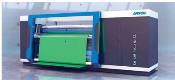
Slika 6: Andritzov sistem teXcal Raconip TT sistem toplotnega utrjevanja s kalandrom; 1 – termokalandar, 2 – odvod termično utrjene koprene [6]
