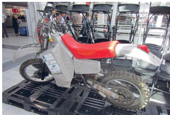
Slika 13: Posamezni deli karoserije motorja so izdelani iz odpadnih vojaških uniform
