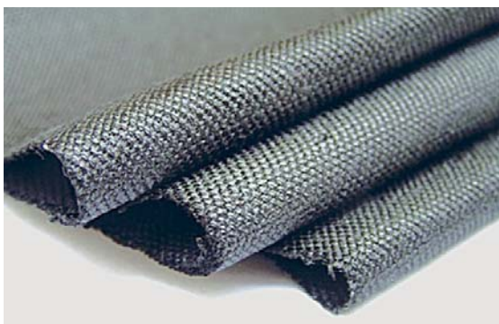
Slika 4: Flexzorb zaščitna tekstilija na osnovi aktivnega ogljika [6]
