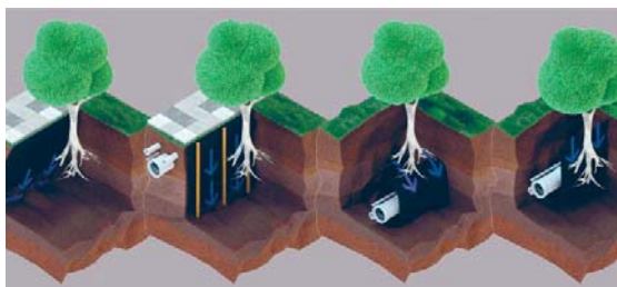
Slika 18: Uporaba premazane kopenske tekstilije pri vgradnji cevovodov [12]
