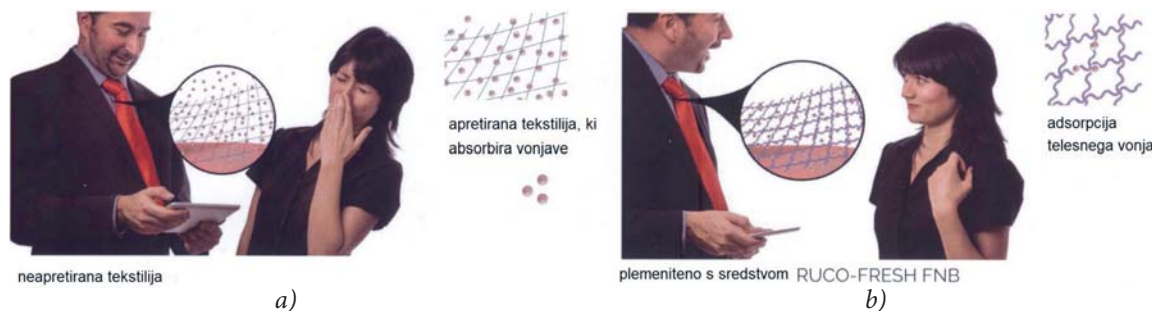
Slika 2: Prikaz delovanja funkcionalnega filma RUCO®-FRESH FNB za nadzor telesnega vonja: (a) neapretirana tekstilija in (b) apretirana tekstilija, ki absorbira vonjave [2]
