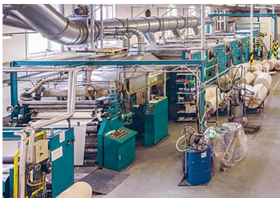
Slika 22: Gumotexova linija za premazane tekstilije; 1 – dovajalni valj, 2 – kompenzator napetosti, 3 – premazovalna valja, 4 – navijanje premazane kopenske [14]
