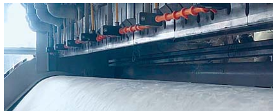
Slika 37: Prikaz izdelave netkane tekstilije melt-blowing za zdravniške maske [20]
