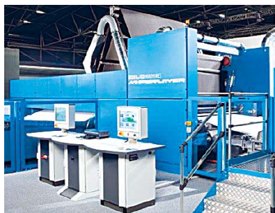
Slika 3: Dilo sistem polaganja Hyperlayer [5]
