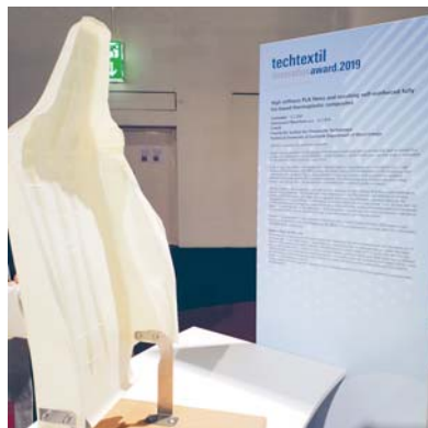
Slika 19: Nagradjeni prototip školjke za avtomobilski sedež BIO4SELF [22]
