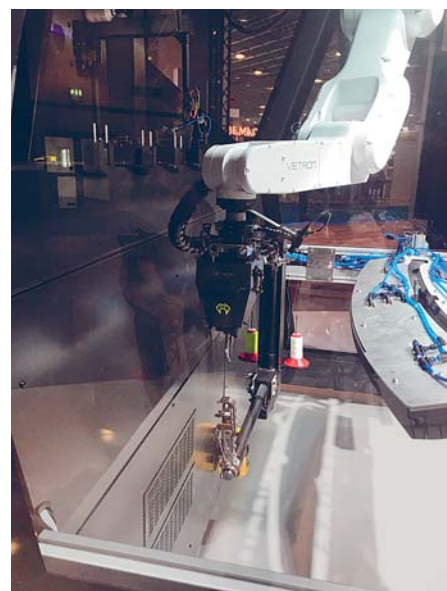
Slika 3: Robotizirana šivalna glava Vetron Viper za šivanje 3-D izdelkov
