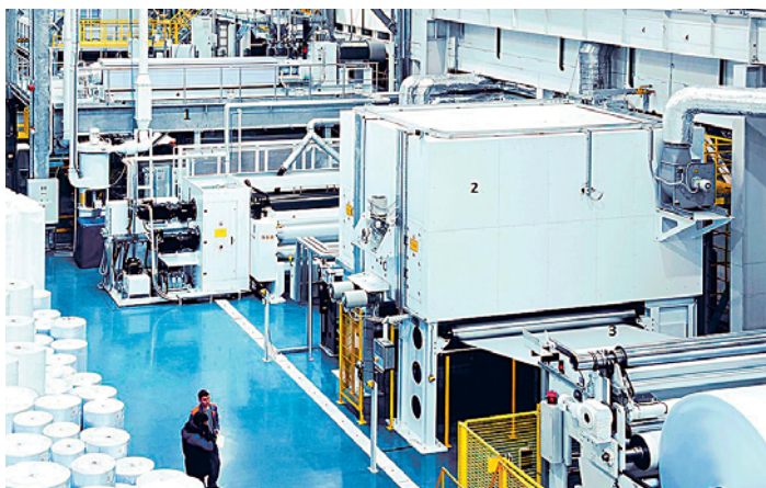
Slika 13: Postopek spunbonding za izdelavo temeljnega sloja netkane tekstilije; 1 – postopek spunbonding za izdelavo temeljnega sloja, 2 – termično utrjevanje s termokalandri, 3 – odvajanje izdelane koprene in navijanje na navitek [9]
