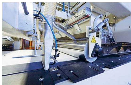
Slika 14: Aerodinamični postopek izdelovalca Oerlikon Neumag za proizvodnjo higienskih tekstilij; 1 – zračni polagalnik, 2 – toplozračni sušilnik za fiksiranje temeljnega sloja [9]
