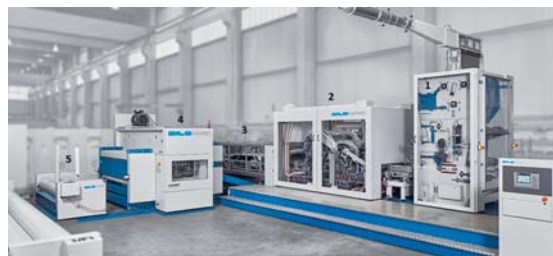
Slika 4: Dilo sistem mehanskega utrjevanja z iglanjem Hypertex; 1 – volumetrični napajalnik mikalnika, 2 – mikalnik z valjčki, 3 – horizontalni križni polagalnik, 4 – utrjevanje z iglanjem, 5 – navijanje izdelane koprene [5]
