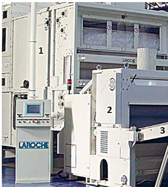
Slika 10: Larochev sistem Flexiloft; 1 – napajalnik, 2 – ohišje s sitastim bobnom in sesalom zraka, 3 – zračno položena koprena [8]
