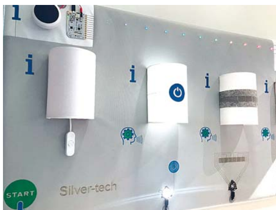
Slika 5: Interaktivni panel z različnimi »tekstilnimi« stikali iz pametnega sukanca Silver-tech
