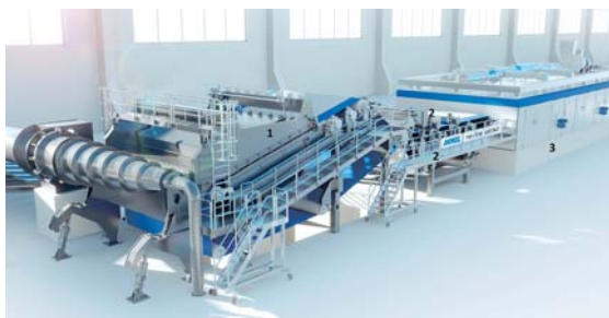
Slika 7: Andritzov sistem Wet laid za mokro polaganje steklenih vlaken; 1 – posoda za pripravo suspenzije kratkih vlaken v vodi v razmerju 1:10000, 2 – sitasti trak za naplavljanje suspenzije, 3 – toplozračni sušilnik [6]
