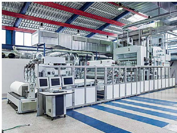
Slika 15: Linija za izdelavo kopren iz recikliranih ogljikovih vlaken; 1 – napajalnik mikalnika, 2 – dovajalni trak s senzorjem za maso dovajanega kopenskega runa, 3 – mikalnik K12 in izdelana koprena [10]
