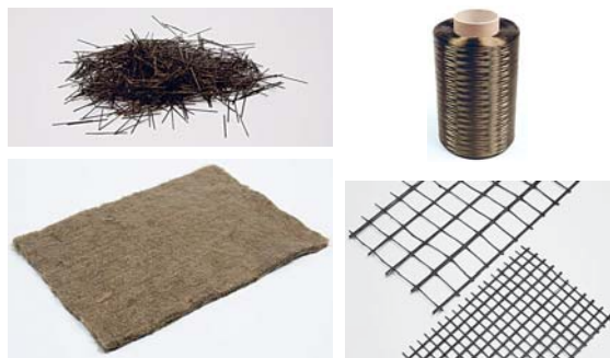
Slika 10: Izdelki iz bazalta: rezana vlakna, filament, ojačitvene mreže in vlaknovine [11]
