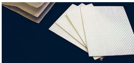
Slika 18: Naravno obnovljive kompozitne plošče, izdelane iz dveh vrst polilaktida (PLA) z različnima tališčema [22]
