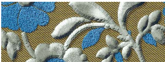
Slika 4: Prikaz simulacije tkanine z gladko in lasasto vezavo ter dodanim votkom, izdelane s programskim modulom 3D textile simulation [12]
