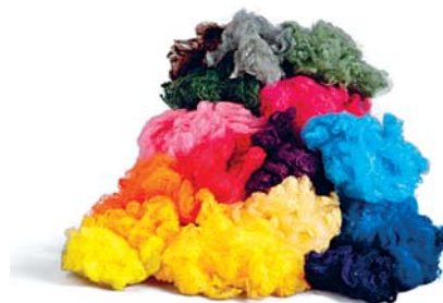
Slika 3: Vlakna Teijinconex® neo – obarvljivi metaaramid [5]
