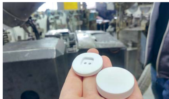
Slika 3: Izsekan žeton in gumb, ki je nastal iz takšnega žetona (fotografija z ogleda proizvodnje)
