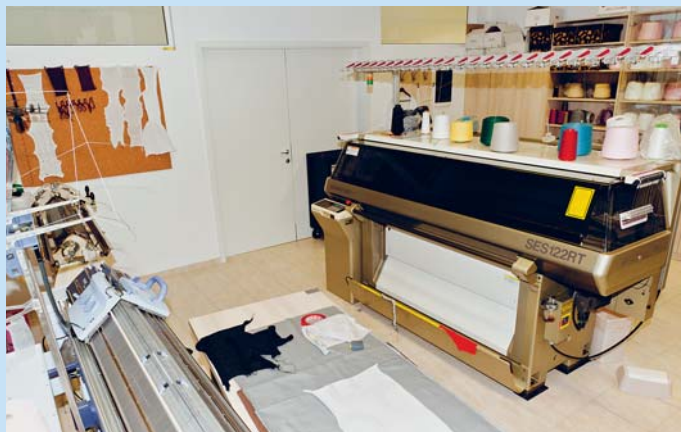
Pletilnica je opremljena z ročnimi in računalniško vodenim pletilnikom.
