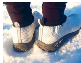
Slika 7: Drugi model obuvala iz mikroporoznega premaza in snutkovnega pletiva, prevlečenega s perforirano plastjo (zunanj del) in večplastne koprene, utrjene s prešivanjem z zadnje strani
