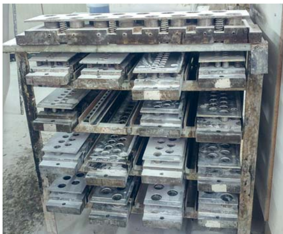
Slika 2: Modeli različnih velikosti za štancanje gumbv iz mehke površine poliestrske plošče (fotografija z ogleda proizvodnje)
