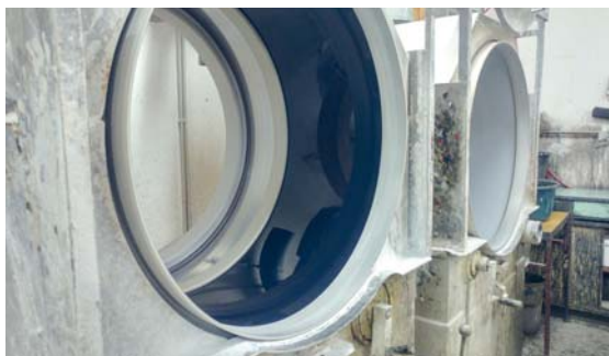
Slika 1: Boben, s pomočjo katerega iz tekoče mase z rotiranjem dobimo enakomerno debelo površino (fotografija z ogleda proizvodnje)
