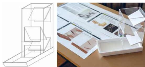
Slika 12: Skica modela Stolp za kockanje, 3-D vizualizacija, in prototip, izdelan iz kapa plošče in pleksi stekla, Rok Kladnik (IOI), foto: Jure Zagoranski (IOI)
