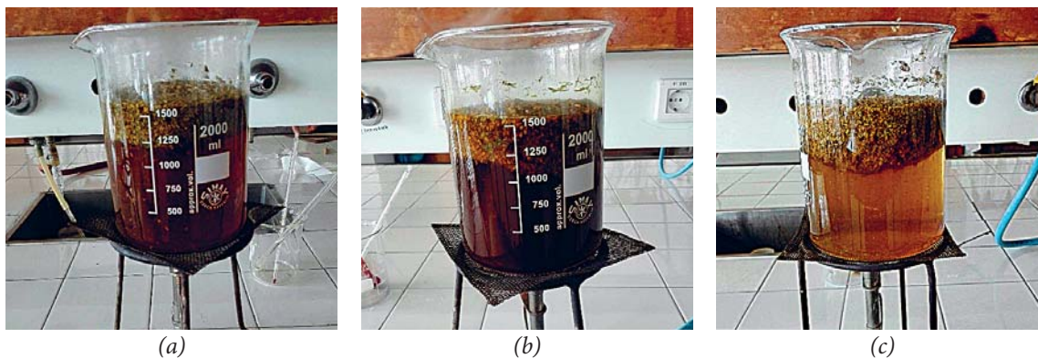
Slika 2: Priprava barvilnih ekstraktov zlate rozge v trdi vodi: nevtralni pH (a), alkalni pH (b) in kisli pH (c)
