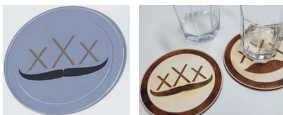
Slika 9: 3-D vizualizacija spominka in izdelek, laser-sko gravirana vezana plošča, Peter Kolar (IOI), foto desno Nataša Dolejši
