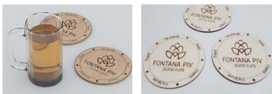
Slika 8: 3-D vizualizacija spominka in izdelek, laser-sko gravirana vezana plošča, Nik Bračič (IOI), foto desno Nataša Dolejši
