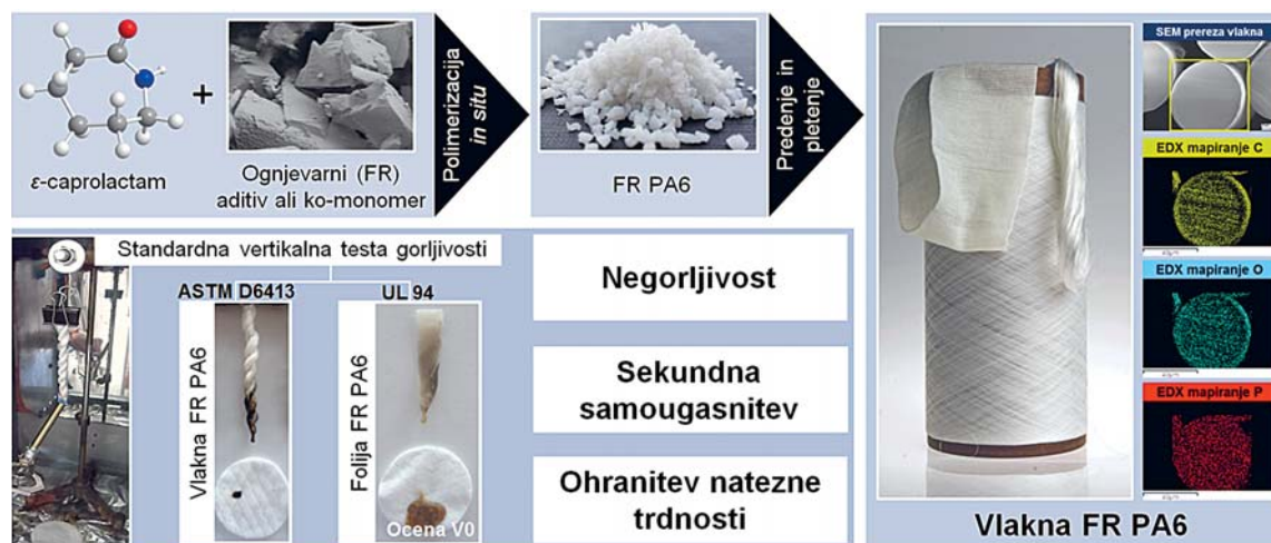
Slika 2: Shematičen prikaz postopka izdelave filamentne preje in pletiva Flaremid6 ter njegove ognjevarne lastnosti
