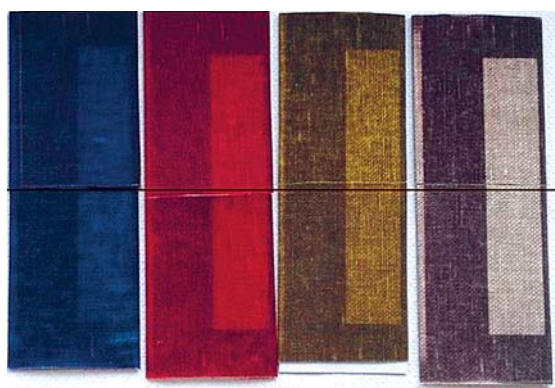
Slika 6: Vzorci, potiskani z mešanico klasičnega pigmenta in črnega termokromnega barvila, po končanem preizkušanju barvne obstojnosti na umetni svetlobi (zgoraj apretirani vzorci, spodaj neapretirani)
