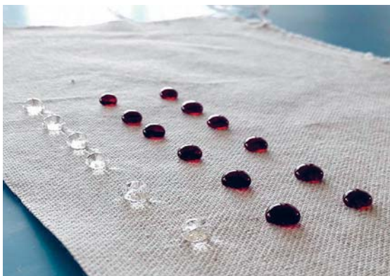
Slika 7: Testiranje vodo- in oljeodbojnosti
