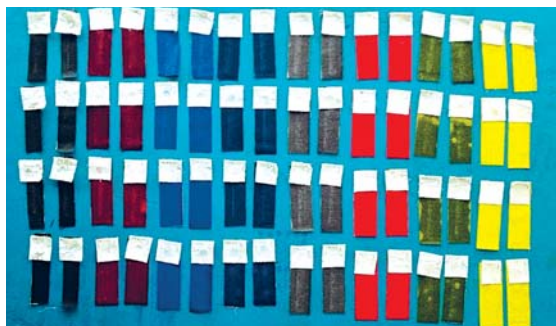
Slika 5: Vzorci po končanem testiranju barvne obstojnosti pri drgnjenju
