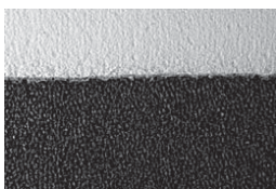
Slika 39: Prevlečeni PU-sloj (umetno usnje) [20]
