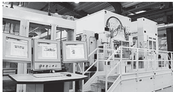
Slika 20: Autefove linije za iglanje, ki delujejo pri povečani širini do 16 m [12]
