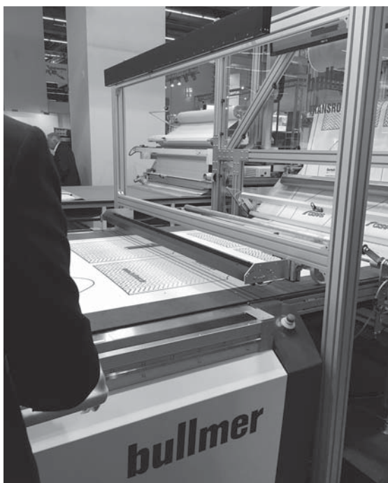
Slika 7: Digitalno krojenje s pomočjo kamere (Bullmer)
