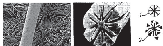
Slika 27: Prikaz vlakna Evolon v primerjavi s človeškim lasom (levo) in njegove segmentne strukture (1) in cepljene strukture (2) (desno) [14]
