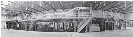
Slika 32: Gumotexova linija za premazovanje tekstilij [17]
