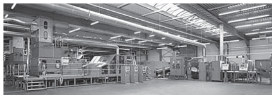
Slika 3: Posebna linija za izdelavo in utrjevanje (iglanje) temeljnega sloja iz recikliranih ogljikovih vlaken [5]
