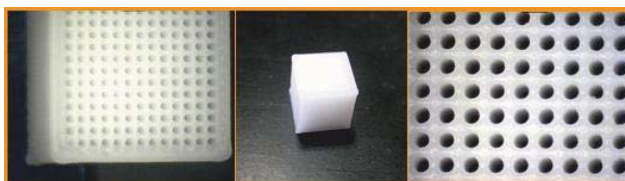
Izdelava mikrostrukturiranih ogrodij iz polikaprolaktona za namene simuliranja žil.
