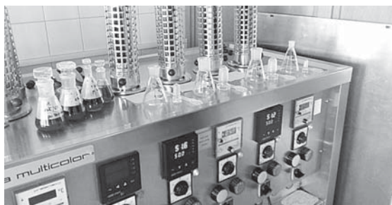
Barvanje prej v laboratorijskem barvalniku
