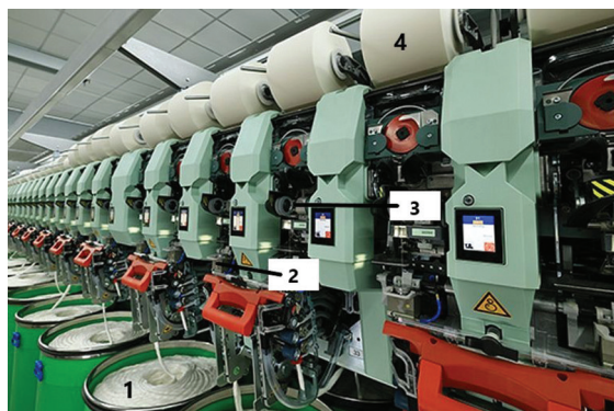
Slika 26: Curkovni predilnik (predilnik air-jet) J70: 1 – lonec s pramenom; 2 – zračni vijnik v obliki votlega vretena; 3 – kontrola kakovosti preje – čistilec preje; 4 – križni navitek [11]
