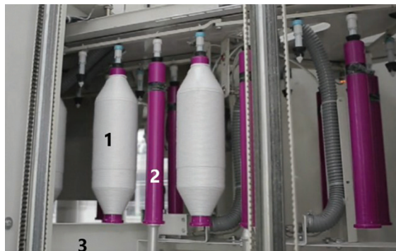
Slika 20: Prikaz bikonusnih navitkov in praznih cev na krilniku F40: 1 – bikonusni navitek predpreje, 2 – prazna cevka, 3 – voz z navitki [7]
