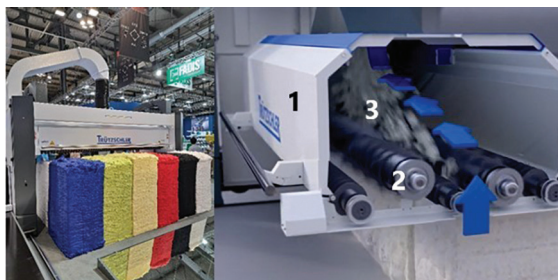
Slika 3: Rahljalnik bal BLENDOMAT BO-P izdelevalca Trützschler (levo) in prikaz rahljalnih enot rahljalnika bal (desno): 1 – ohišje rahljalnika bal, 2 – rahljalna enota (valj), 3 – zrahljano predivo (kosmi in kosmiči) [6]
