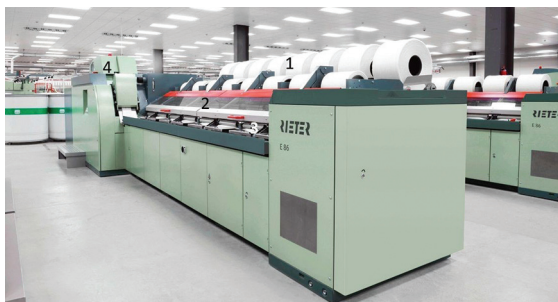
Slika 18: Česalnik E 86 s sistemom ROBOLap: 1 – svitki, 2 – česalno mesto (osem česalnih glav), 3 – združevalni trak, 4 – združevanje in raztezanje česanih pramenov in odlaganje česanega pramena v lonec [7]
