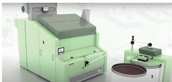
Slika 12: Mikalnik C81 s fleksibilnim sistemom Q-Paket: 1 – mikalnik s pokrovčki C81, 2 – pokrov lonca z lijakom, 3 – lonec za odlaganje pramena [5]
