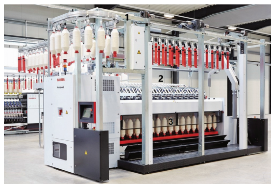
Slika 22: Prikaz krilnika AutospeedM izdelovalca Saurer: 1 – avtomatski transport praznih cev in navitkov stenja, 2 – raztezala (trivaljna dvojeremenčna raztezala), 3 – voz z navitki stenja [9]
