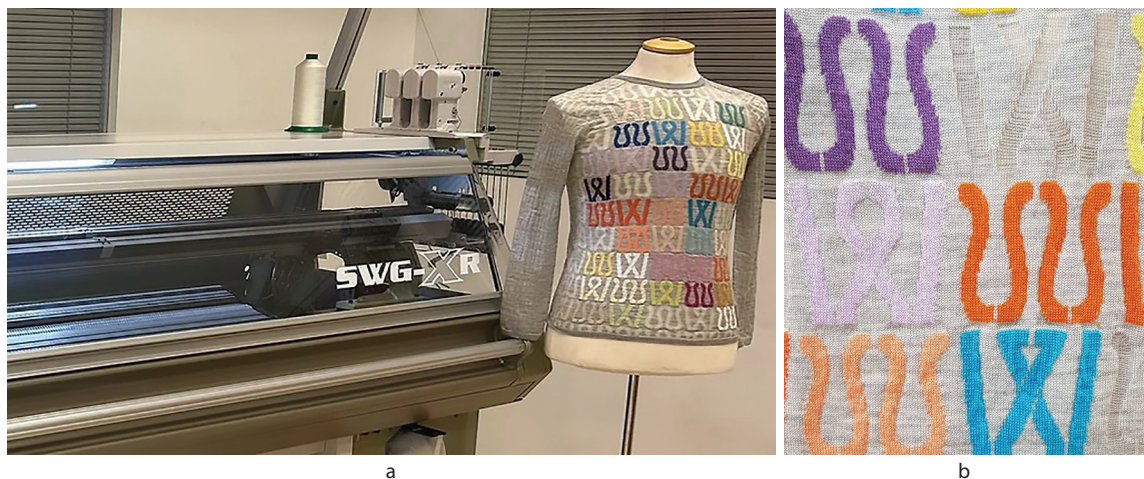
Slika 4: Večbarvni žakarski brezšivni pullover, napleten na pletilniku Shima Seiki SWG-XR ( https://www.shimaseiki.co.uk/ )
