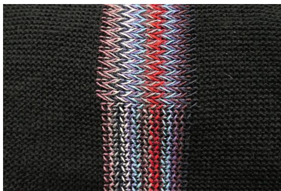
Slika 3: Nov pletilnik ADF 530-16/4 ki WWK omogoča pletenje snutkovnemu pletivu podobnih struktur ( https://kohantextilejournal.com/wp-content/uploads/2023/06/pattern_1_ADF_530-164_ki_WWK_E7.2.webp ).
