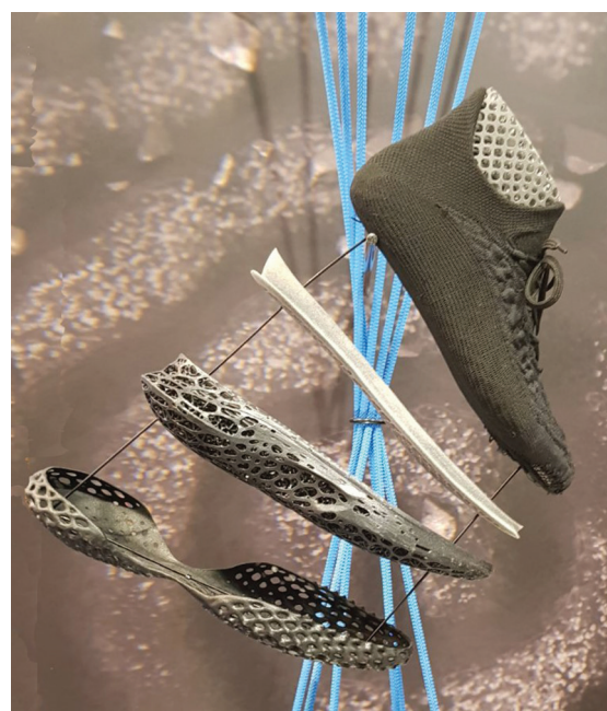
Slika 14: Trajnostna športna obutev, sinergija pletenja in 3D-tiska (foto A. Pavko Čuden)
