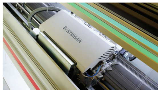
Slika 6: Odprte sani pletilnika Steiger Antares 2.185 (vir: https://steiger-textil.ch/project/antares-2-185-e3/ )
