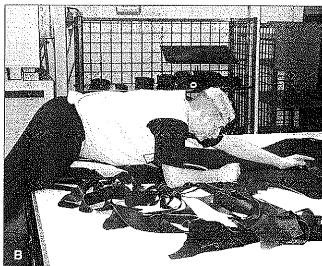
Slika 11: Delo označevalca: A – označevanje napak in uporabne širine na koži, B – pobiranje krojnih delov z delovne površine stroja za razrez usnja
